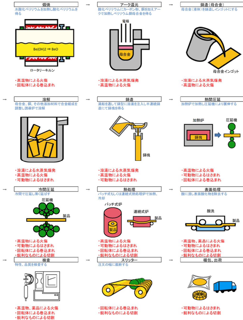
[図Ⅱ-12-11 ベリリウム製造フローと主な潜在危険性(ベリリウム銅合金展伸材)]
