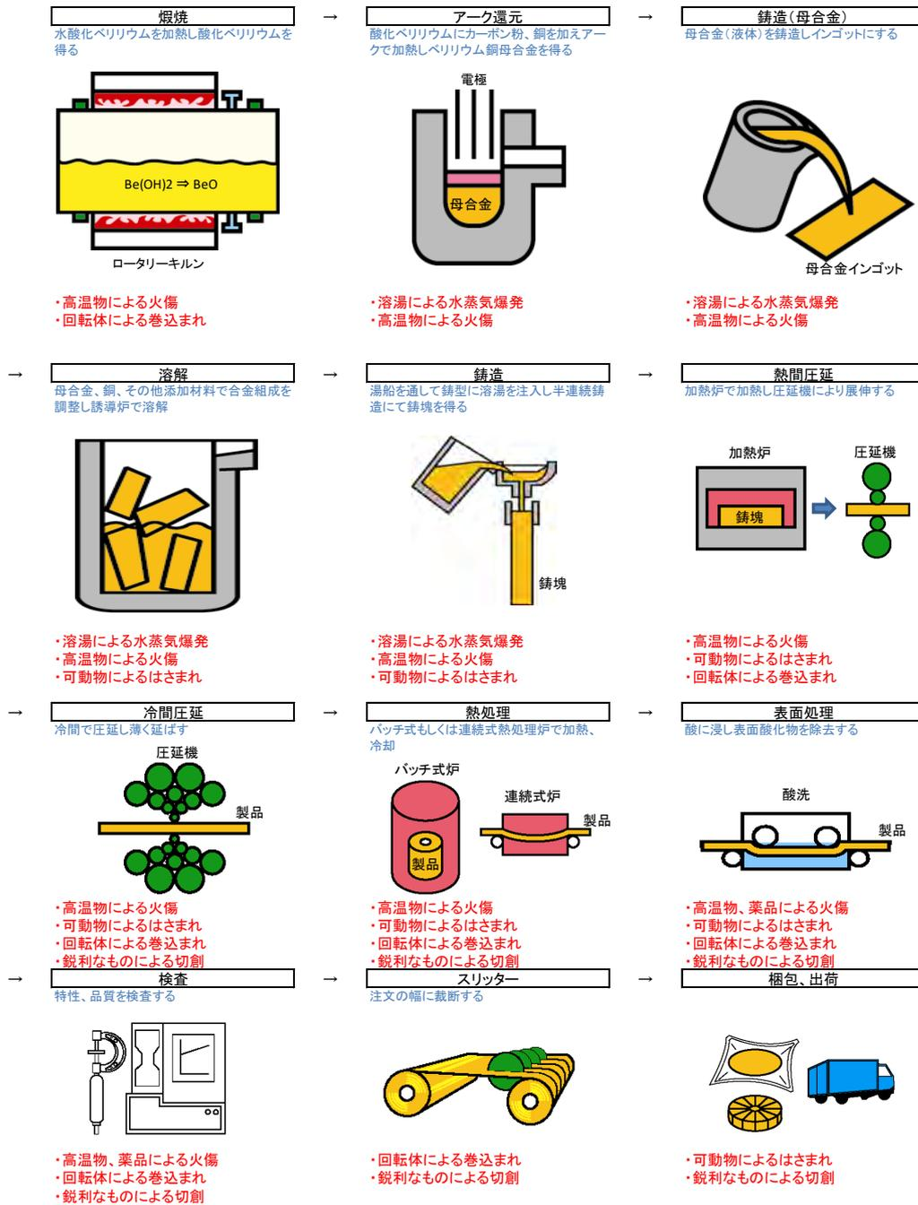
[図Ⅱ-12-12 ベリリウム製造フローと主な潜在危険性(ハザード)(ベリリウム銅加工品)]
